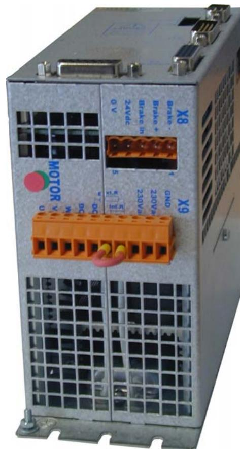
Le variateur ServoPac TT est équipé d'une résistance de décharge interne de 100  $\Omega$  / 35 W. Pour la connecter, il suffit de réaliser un pont de câblage entre les pins 6 et 7 du connecteur X9. Si la puissance nominale de la résistance de décharge nécessaire pour l'application est supérieure à 35 W ou si la puissance impulsionnelle est supérieure à 1500 W, il faut monter une résistance extérieure de puissance supérieure de type dp 50/200.
