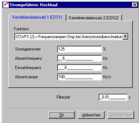
Bild 5.85 Register „Stromgeführter Hochlauf“
