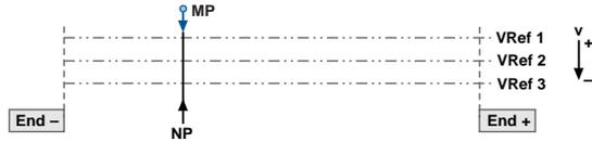
**Bild 4.45** Referenzfahrttyp 0. Die aktuelle Istposition wird als Referenzpunkt gesetzt. Es wird keine Referenzfahrt ausgeführt. Beispiel: Transportband.
