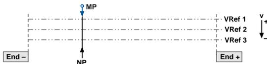
**Bild 4.34** Referenzfahrttyp 0. Die aktuelle Istposition wird als Referenzpunkt gesetzt. Es wird keine Referenzfahrt ausgeführt. Beispiel: Transportband.
